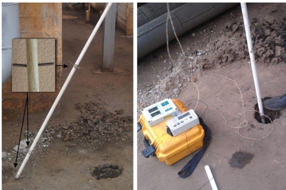
Рис. 4.21 Вид зонда. Выполнение скважинных измерений
