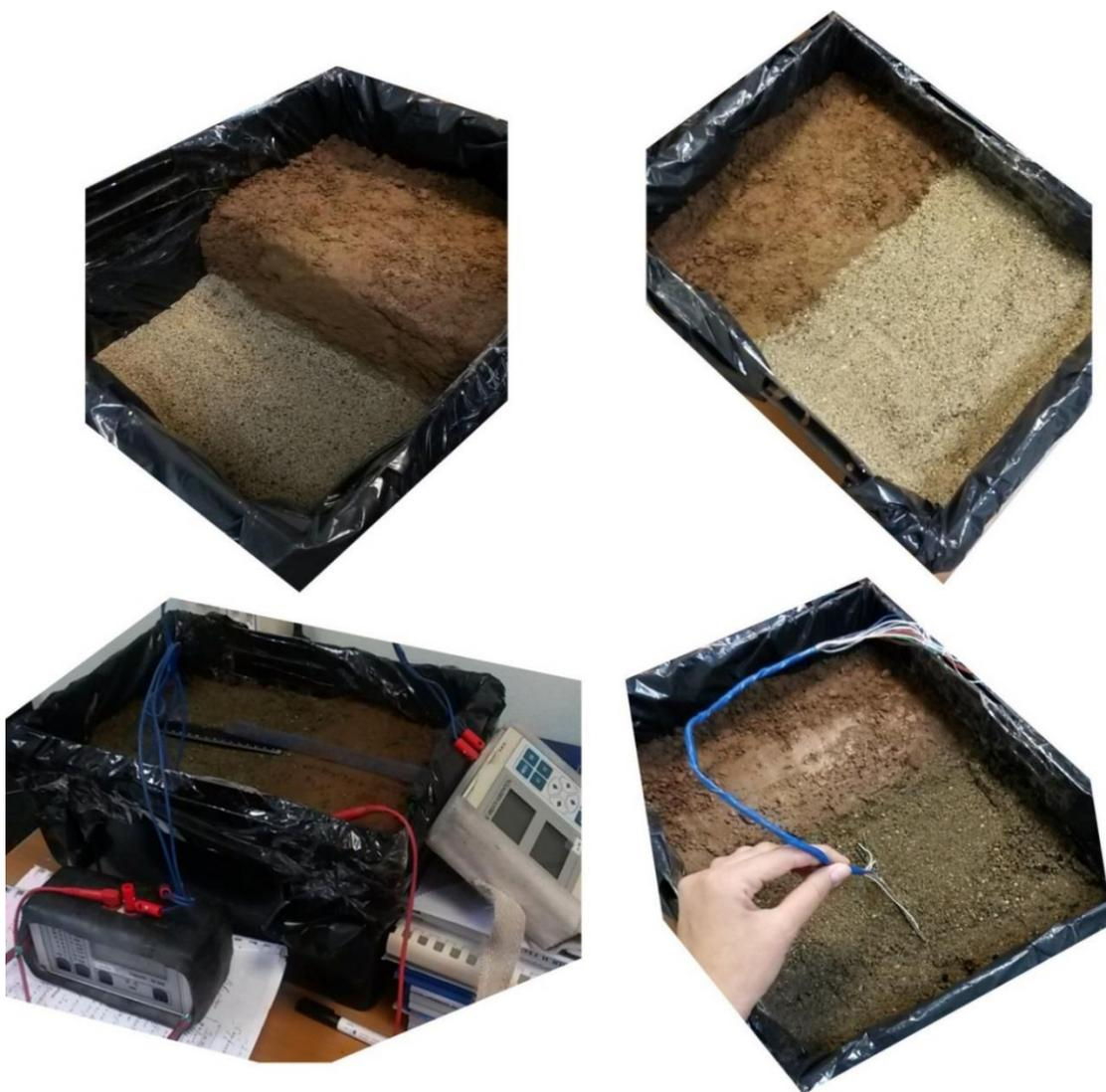
Рис. 4.15 Физическое моделирование в двухслойной среде
