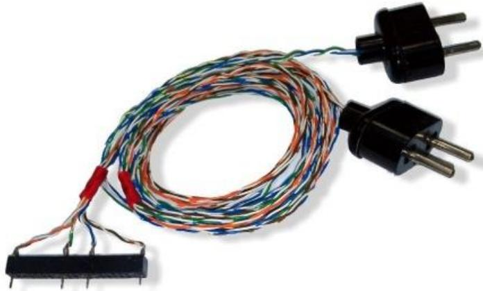
Рис. 2.15 Вид четырехэлектродной микроустановки AMNB
